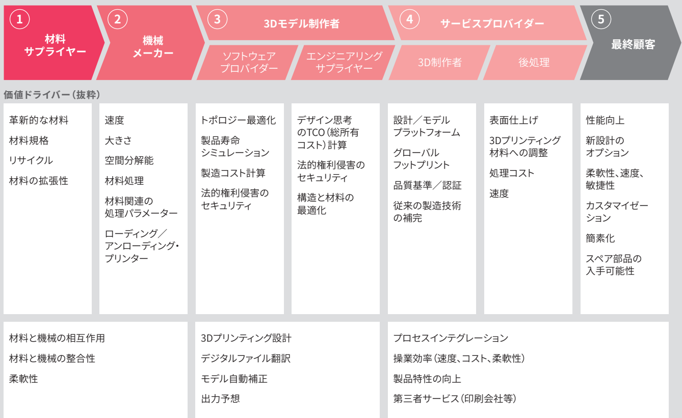
図表2 3Dプリンティングが大量生産でもコスト競争力を持つためには、バリューチェーンのすべてのプレイヤーが事業プロセスを最適化しなければならない
